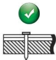
Рис. 2 Пример правильной забивки гвоздей при монтаже продукции.
